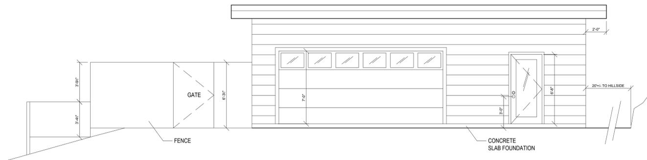
**3 GARAGE - S/W FACING EXTERIOR ELEVATION**
