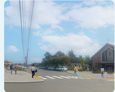
Extensiones de acera y cruces peatonales de alta visibilidad en la intersección de McDougall Street y Preston Street
