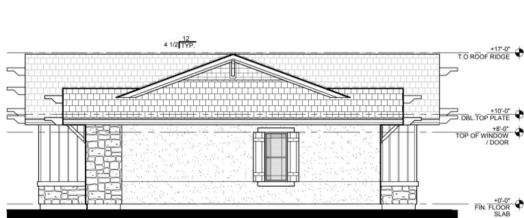
RIGHT SIDE ELEVATION - BUILDING TYPE 2 - A / A / A UNITS (LEFT SIDE SIMILAR)
