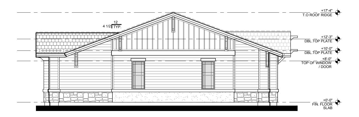
RIGHT SIDE ELEVATION - BUILDING TYPE 5 - B1 UNITS
